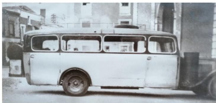
Car GRIMAULT Gazogène en 1983 devant l'église de Chaudron, avec sa réserve à l'arrière et la chaudière sur l'aile avant.
